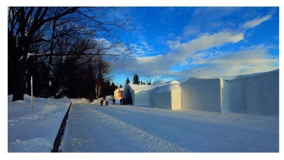
冰雪酒店的奥妙在于,一 米多厚冰雪堆砌而成的冰 房间,具有百分百的挡风 效果。因此,即使室外降 到零下30度,室内也维 持着零下5度左右的"高 温"。
